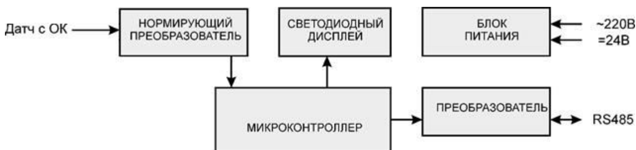
Рис. 12 Структурная схема выносного табло тахометра ВК-371ТД.
