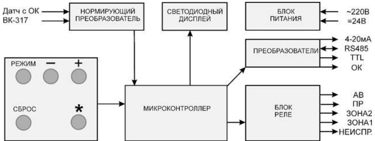
Рис. 8. Структурная схема вторичного блока тахометра ВК-371Д
